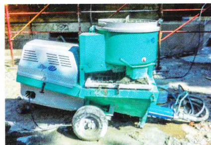
Intonacatrice IMER Step 120 utilizzata per la proiezione della malta da ripristino
