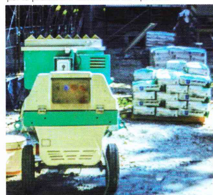
Intonacatrice IMER Step 120 utilizzata per la proiezione della malta da ripristino
